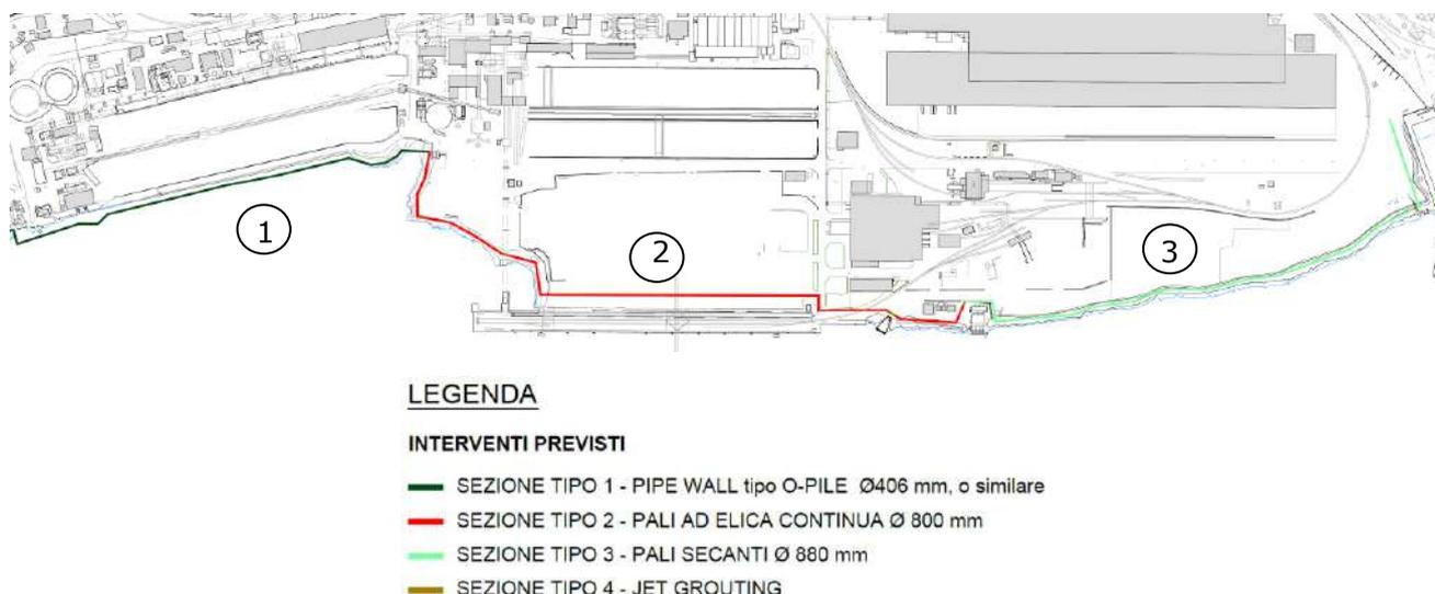
Figura 9-3: marginamento di progetto, ubicazione diverse tecnologie
