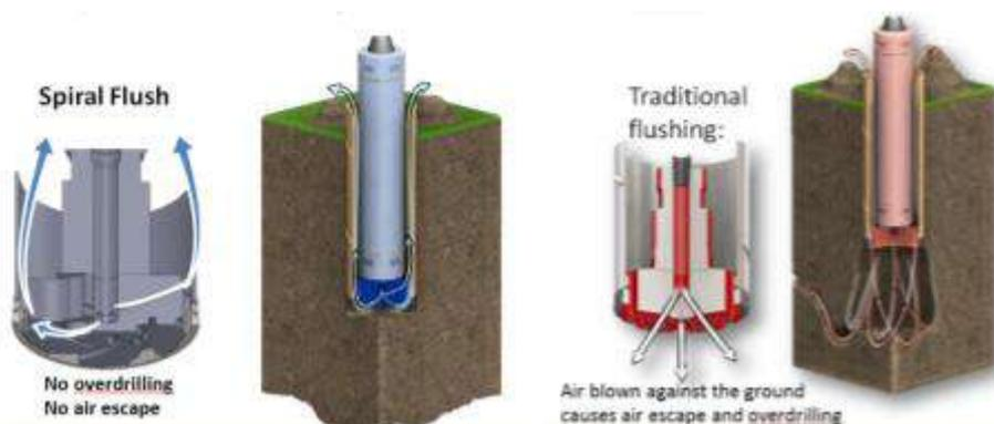
Figura 9-7: confronto schema di funzionamento sistema Spiral Flush (sx) sistemi tradizionali (dx)
