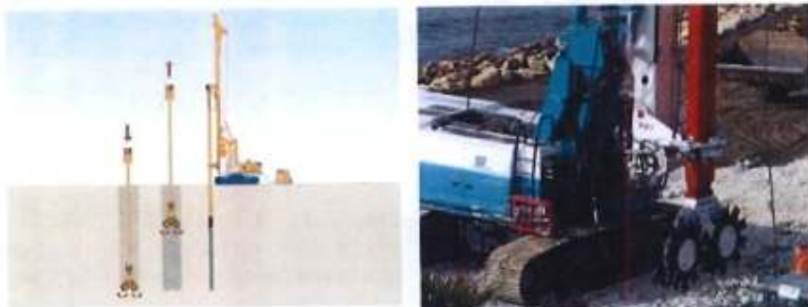
Figura 9: Tecnologia CSM - fasi di esecuzione.
