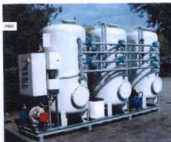
Foto impianto di trattamento dotato di n.3 filtri e c.a.
