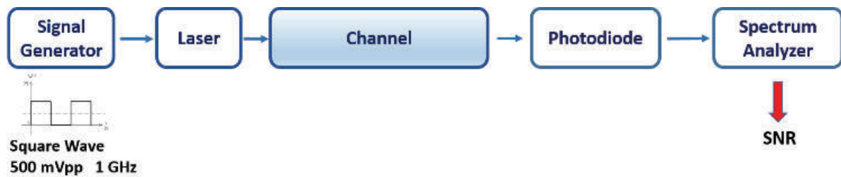
Figura 4: Rappresentazione schematica della procedura utilizzata per eseguire le misure sperimentali
