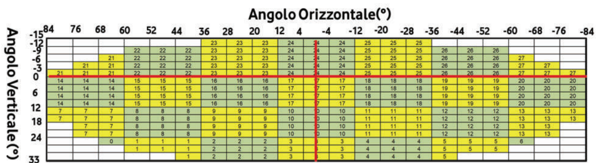
Figura 3 – Rappresentazione grafica dei 28 settori angolari dell'antenna mMIMO
