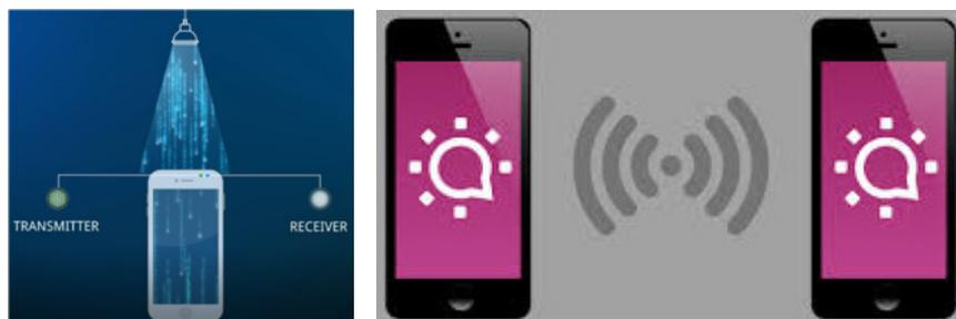
Figura 3. Flash e foto-camera integrati in uno smartphone, utilizzabili come Tx e Rx, rispettivamente, per comunicazioni VLC. Due smartphone possono comunicare tra loro con un link VLC duplex
