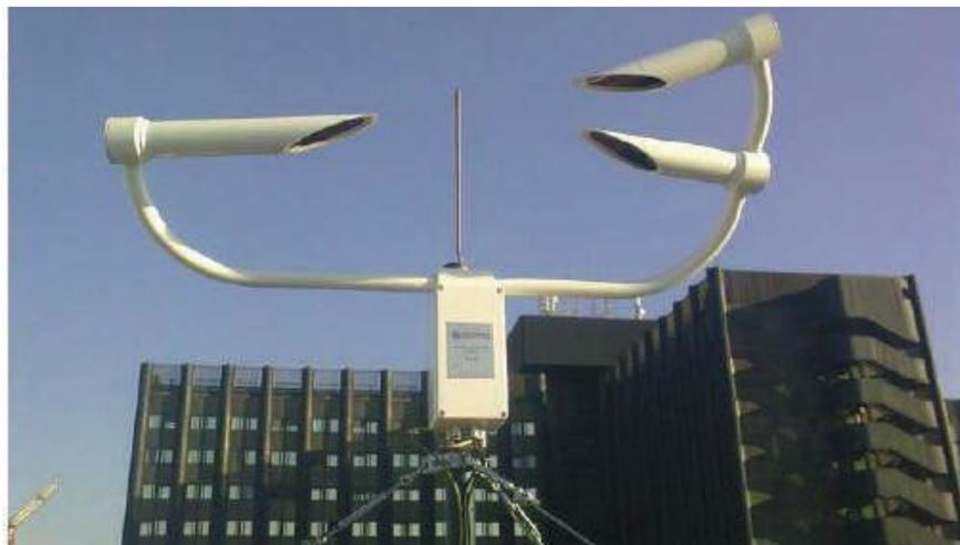
Figura 4. Disdrometro-visibilimetro
